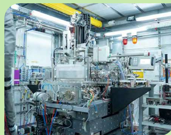
La estación experimental Sapoti, parte de la línea de luz Carnaúba del acelerador Sirius, podrá alcanzar resoluciones de hasta un nanómetro en experimentos de imagen con rayos X. Foto: Divulgación CNPEM.
