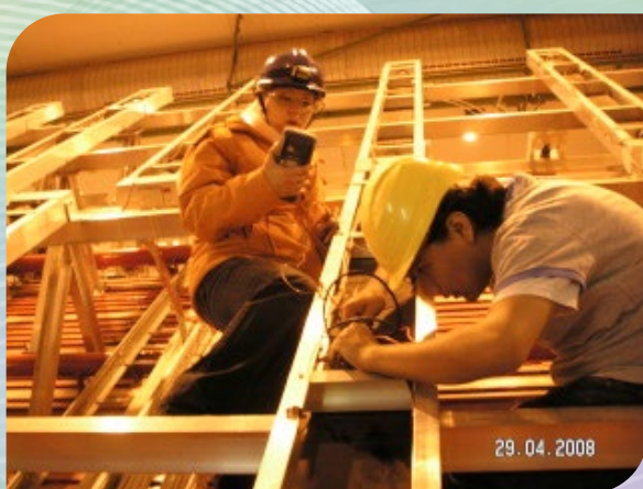
Instalación de centelladores ACORDE sobre el magneto de ALICE. En la foto: Mario Rodríguez (BUAP) e Ivonne Maldonado (UNAM).
