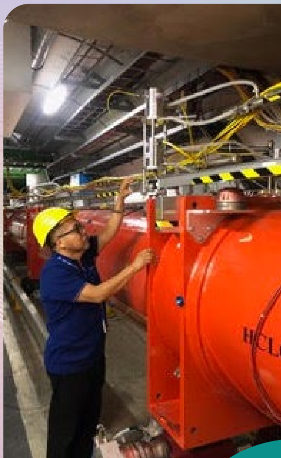
Instalación de centelladores ACORDE sobre el magneto de ALICE. En la foto: Mario Rodríguez (BUAP) e Ivonne Maldonado (UNAM).
