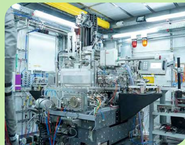
La estación experimental Sapoti, parte de la línea de luz Carnáuba del acelerador Sirius, podrá alcanzar resoluciones de hasta un nanómetro en experimentos de imagen con rayos X. Foto: Divulgación CNPEM.
